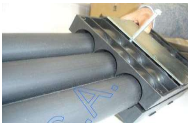
3.19 - União de tritubo através de acessórios eletro-soldáveis
